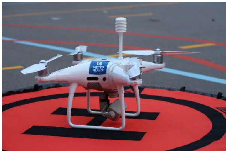
Figure 38: Drone permettant de caractériser l'effet rafraîchissant des parcs végétalisés en conditions de canicule déployé durant la campagne PANAME. Source : DESR/CNRM/GMEI.
